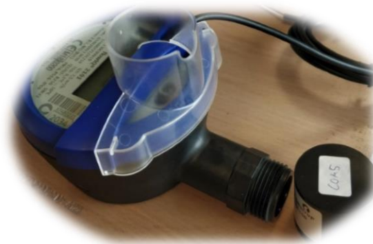
Impulsinterface Typ 66-99-143 mit optischem Support Typ 3026-867 flowIQ® wired
